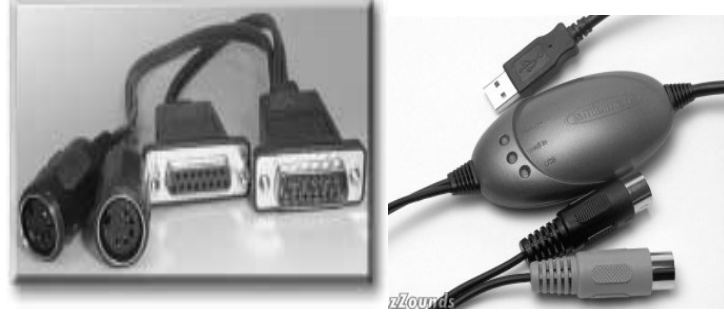
Resim 3 ( Bilgisayarın ses kartı üzerindeki joystick portu ile elektronik müzik aleti [ Synthesizer, Digital Piyano, Midi Kontrol Klavyesi v.b.] arasında haberleşmeyi sağlayan MIDI kablosu
